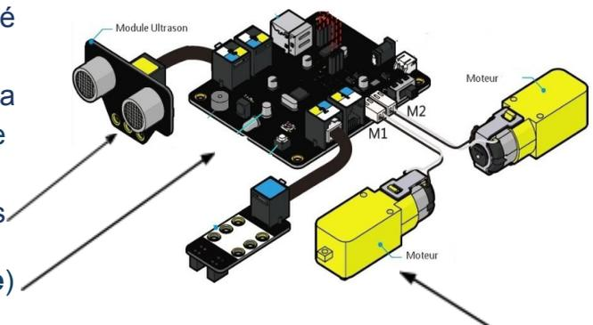
Un **système embarqué** est un système **électronique** et **informatique autonome** capable de **réagir en temps réel** et de **réaliser des tâches précises** (déplacements, préhension...).
